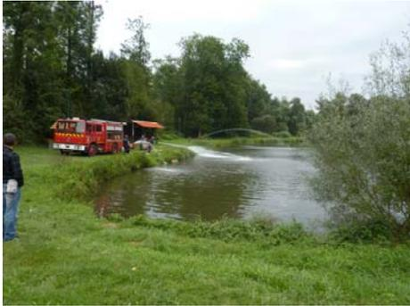
BEDELL le matériel mis en place permet rapidement d'injecter de l'eau dans l'étang. Trois jets puissants permettent de réoxygéner.
